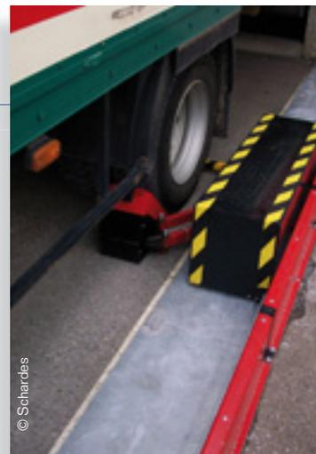
Dispositif de calage semi-automatique avec mise en place à commandes à appui maintenu
